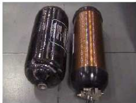
figure 50: Gauche: Réservoir embarqué Ovonix de 3 Kg H 2 à 100 bar Droite: Réservoir Hydrogène comprimé Dynetek de 0,78 Kg H 2 à 350 bar
